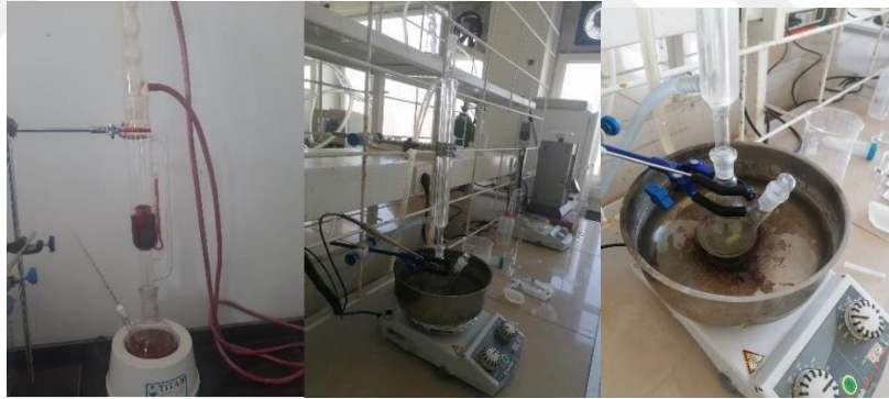
Resim 3.2 : Hibiskus bitkisi çiçeklerinin Soxhlet ekstraksiyon düzeneği ile ekstraksiyonu
