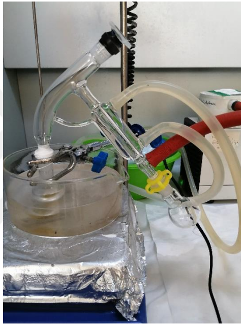
Şekil 4.3 Monomer saflaştırmada kullanılan mikro-distilasyon düzeneği
