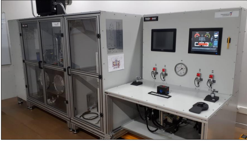
Resim 6.3. Servo valf test cihazı
