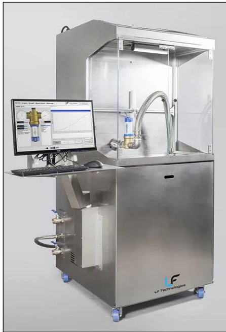
Şekil 4.1. LF technologies basınç ve debi test sistemi
