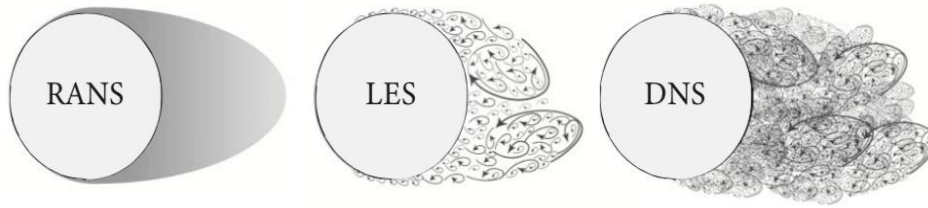
Şekil 2.5 : Bir dairenin arkasındaki türbülans izi, farklı sayısal yöntemler arasındaki çözünürlük farklarını göstermek için kullanılmıştır. Çözünürlük ve hesaplama maliyetleri, RANS'tan LES'e ve oradan da DNS'e doğru artmaktadır. (Hart, 2016).
