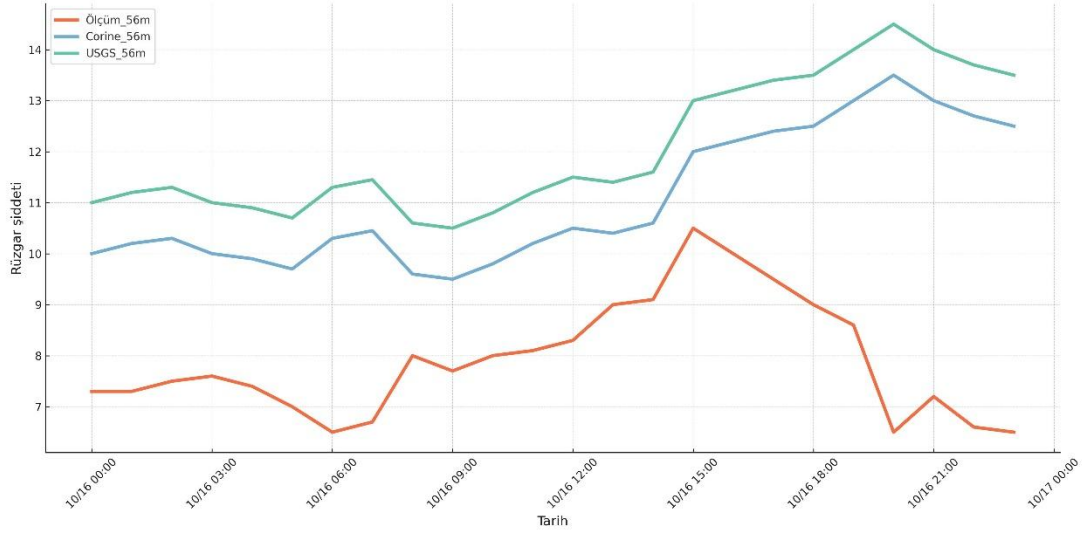
Şekil 4.19 : 56m için model ve gözlem verilerinin saatlik ortalama rüzgâr şiddeti.
