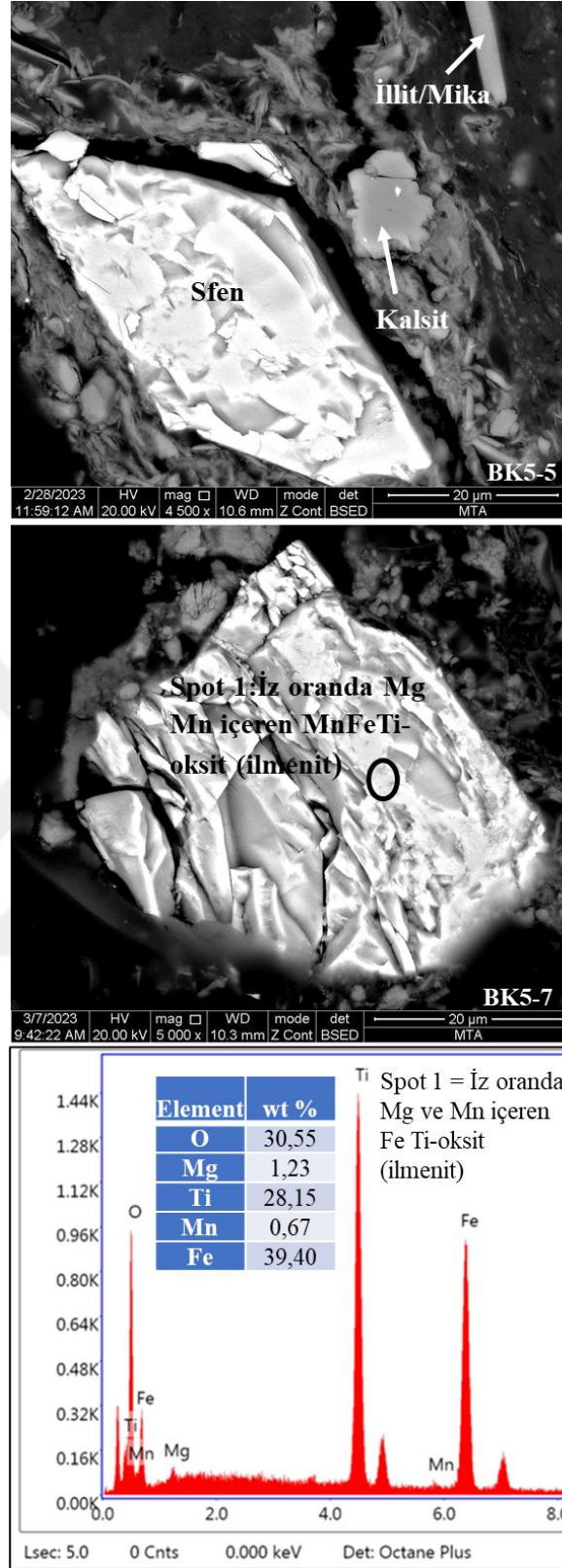
Şekil 5.29. Tez kapsamında BK5-7 nolu örneğin parlak kesiti üzerinde SEM-EDS yardımıyla tanımlanan illit/mika, kalsit, sfen ve iz oranda Mg ve Mn içeren Fe Ti-oksit (ilmenit?) minerali.
