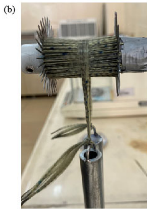
Nano B 4 C katkılı para-aramid yapıda üç ipliğin sürtünme testi
