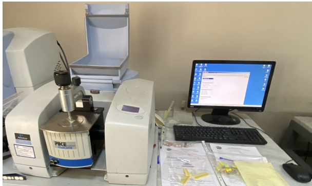
Şekil 2.31. FTIR cihazı ve örnek ölçümlerin bilgisayarlı ortamda Exel formatında verilerin ileriki işlemler için depolanması.
