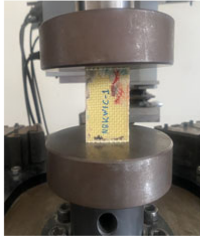
Şekil 2.19. Para-aramid/epoksi kompozit yapının (8 katlı) fişkür yardımı ile katarası basma (aksiyal) testi işlemi.
