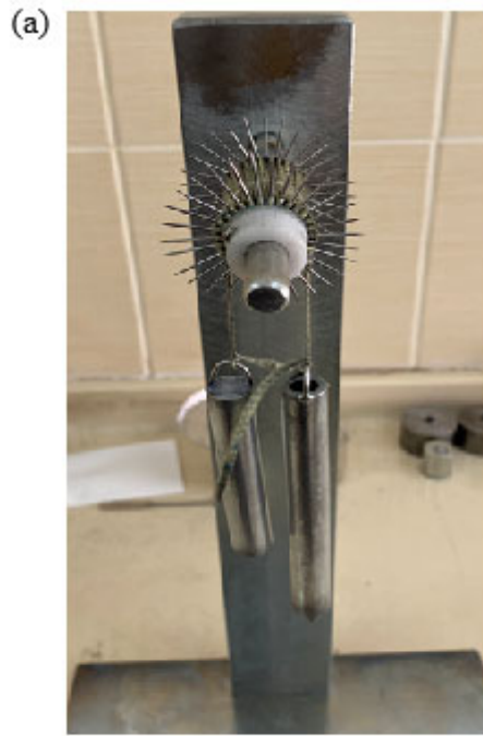
Nano B 4 C katkılı para-aramid yapıda tek ipliğin sürtünme testi
