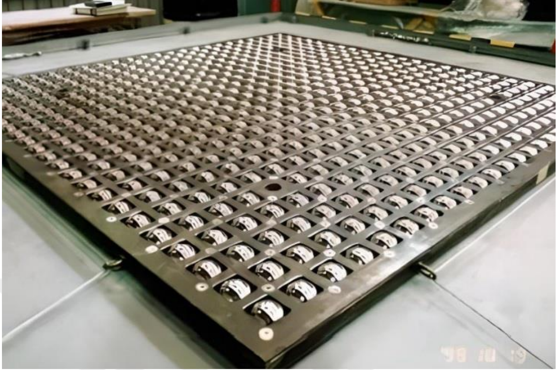
Şekil 3.11 Çelik bilya katmanlı izolatör
