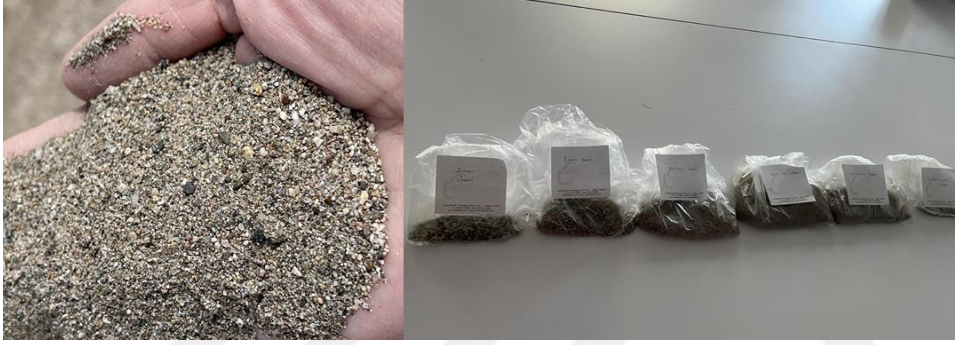
Resim 3.2. KYH tasarımında kullanılan ince agregada
