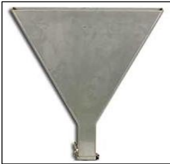
Resim 3.6. Mini V hunisi testi
