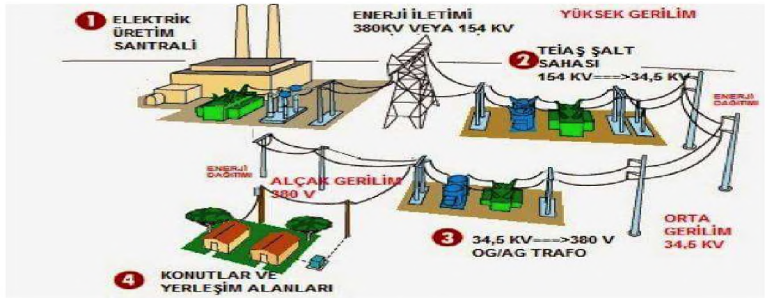
Şekil 4. 1. Türkiye’de Üretilen Elektrik Enerjisinin İletim ve Dağıtım
