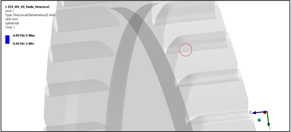
Şekil 4.1 Z53 Dişlisi W3R3 Geometrisi 1 Numaralı Köşenin Eksenel Kayması
