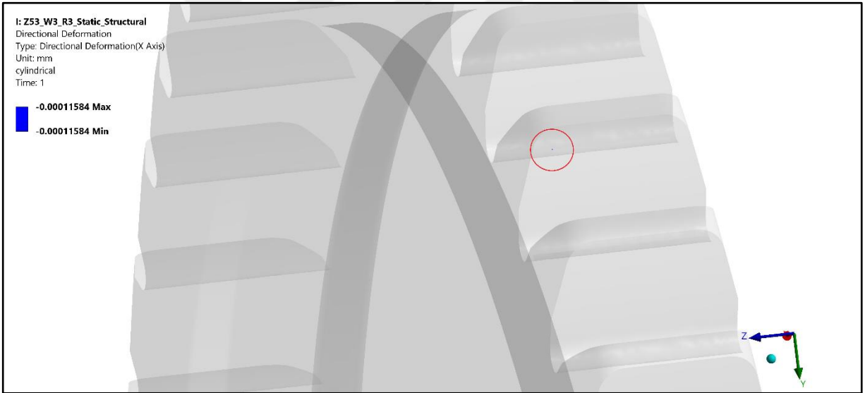
Şekil 4.2 Z53 Dişlisi W3R3 Geometrisi 1 Numaralı Köşenin Radyal Kayması
