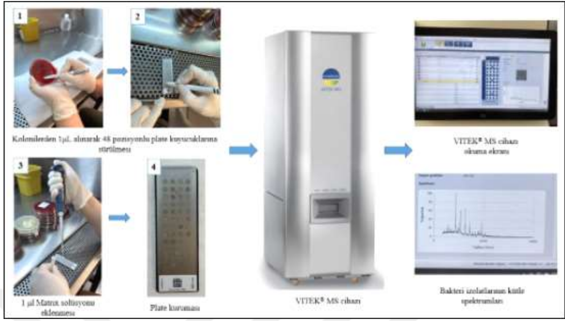
Şekil 3.3.1. Kütle spektrometrisinin numune hazırlığı
