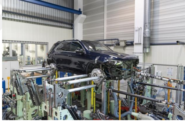
Şekil 2.14 Dingil merkezinden tahrikli prototip araç seviyesinde yapılan test [34]
