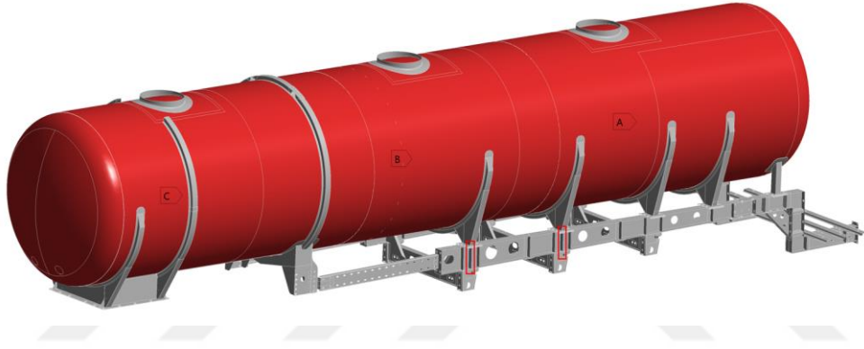
Şekil 5.47 Şasi ayna sacı üzerinde oluşan yorulma hasarları için tasarlanan dikme destek sac parçalar
