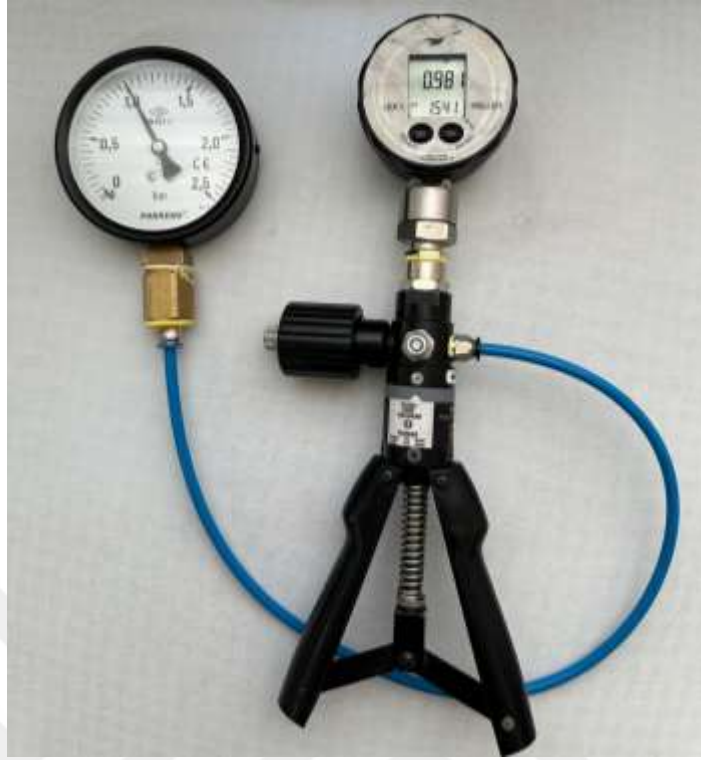
Şekil 5.3. Basınç Ölçer Kalibrasyon Düzenegi
