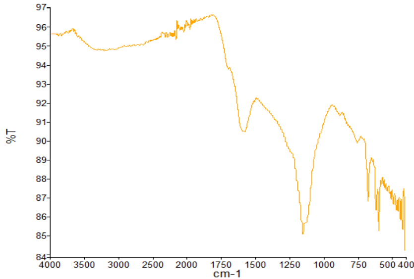
Şekil 4.15 H 2 SO 4 ile aktive edilmiş 400 °C’ta karbonize olmuş modifiye aktif karbonların FT-IR grafikleri
