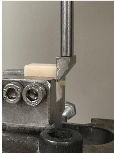
Şekil 3-20. Universal test cihazının ucunun örnekte konumlandırılması
