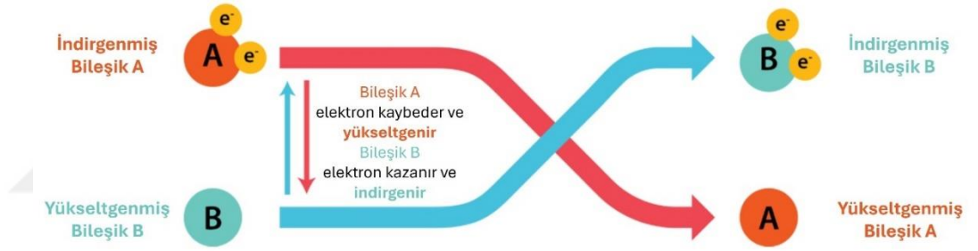
Şekil 2.5 Redoks reaksiyonlarının çalışma mekanizmasını gösteren diyagram (Bruslind, L., 2019'dan uyarlanmıştır).
