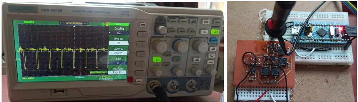
Şekil 3.25. FDD devremizin Interrupt girişinin osiloskop ile test edilmesi
