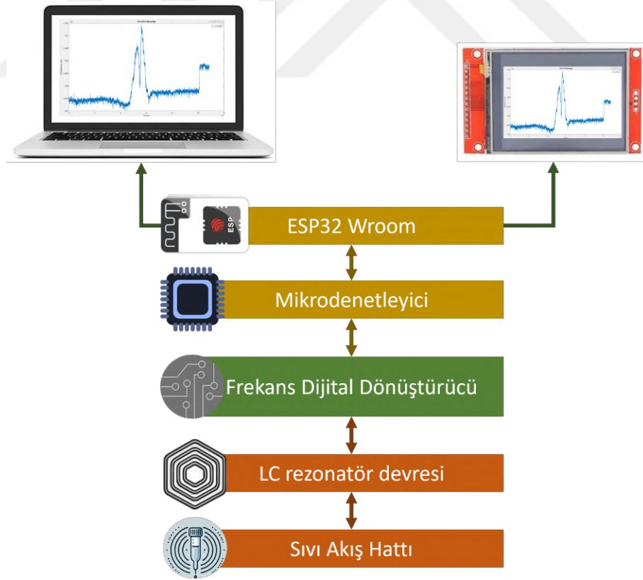
Şekil 3.1. Manyetik algılama sistemine ait temel bileşenlerin blok diyagramı
