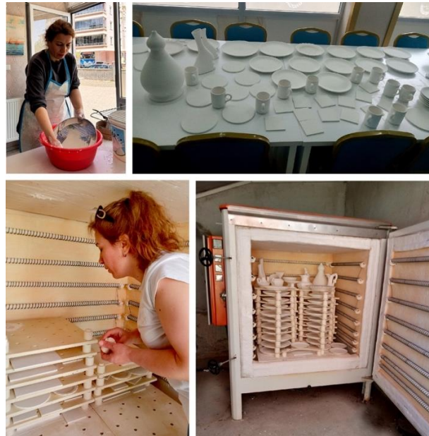
Şekil 7.5. Yapılan çini ürünlerinin sırlanma ve fırınlanma işlemleri. (Tasarım ve uygulama: Derya Aydın, 2025).
