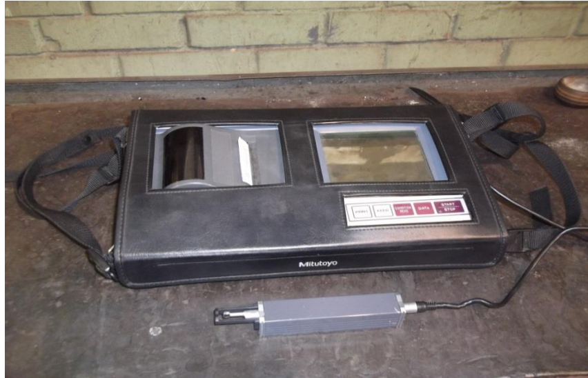
Şekil 2.7. Yüzey Pürüzlülük Ölçüm Cihazı (Mitutoyo SJ-301).
