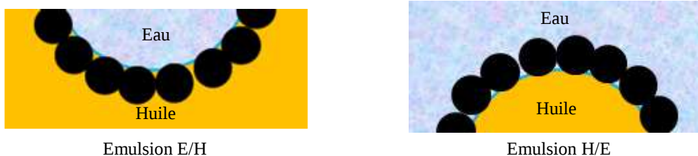
Figure 22 : Schémas d'émulsions stabilisées par des particules dont la courbure dépend de l'angle de contact.
