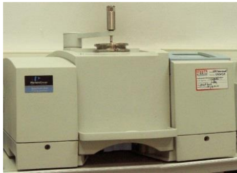
Şekil 5. 7 Fourier Dönüşümlü Kızıl Ötesi Spektroskopi cihazı
