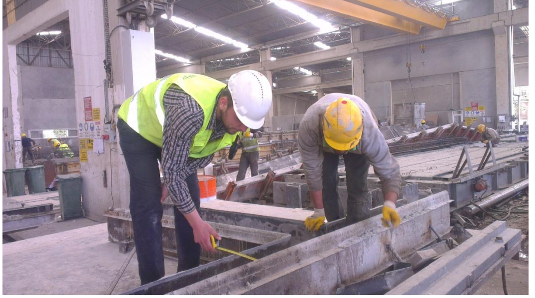
Şekil 3.3.2 Deney elamanı kalıbının kontrolü
