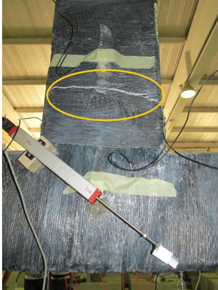
Şekil 5.5.3. Deney sonrası zarar gören CFRP ve eğilme çatlağı bölgesi
