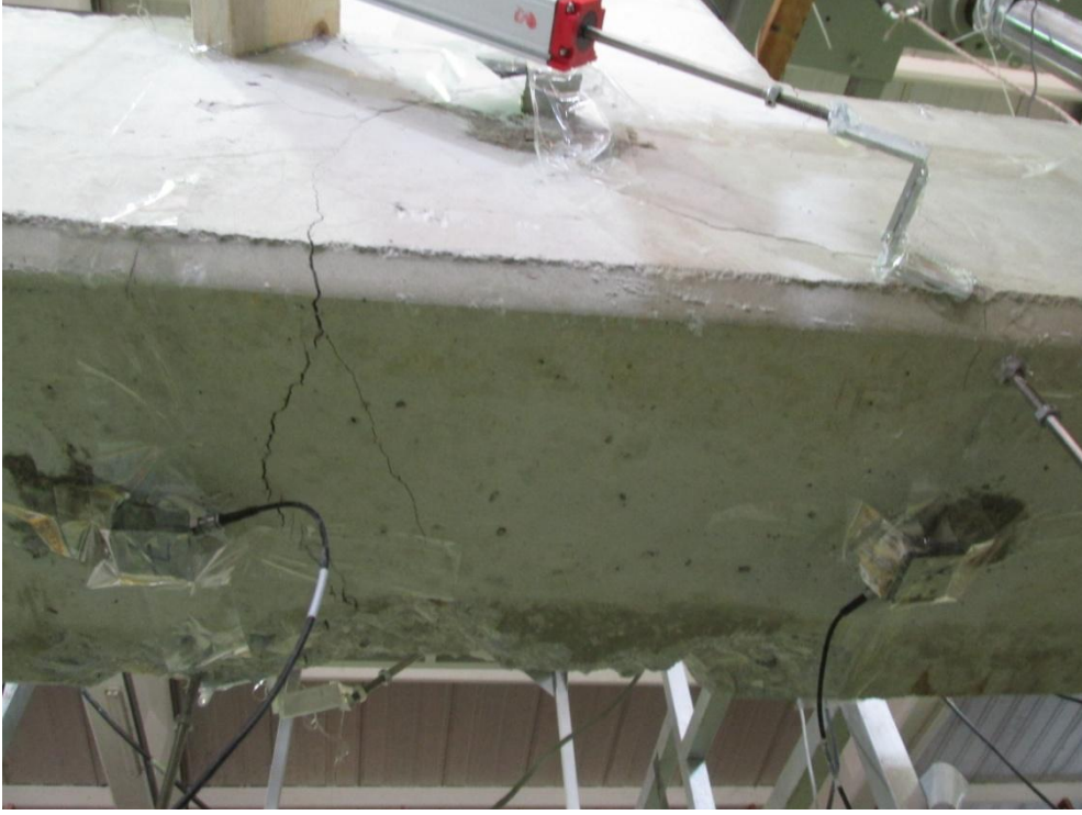
Şekil 5.3.5. Deney sonrası gözlemlenen çatlak ve deformasyonlar
