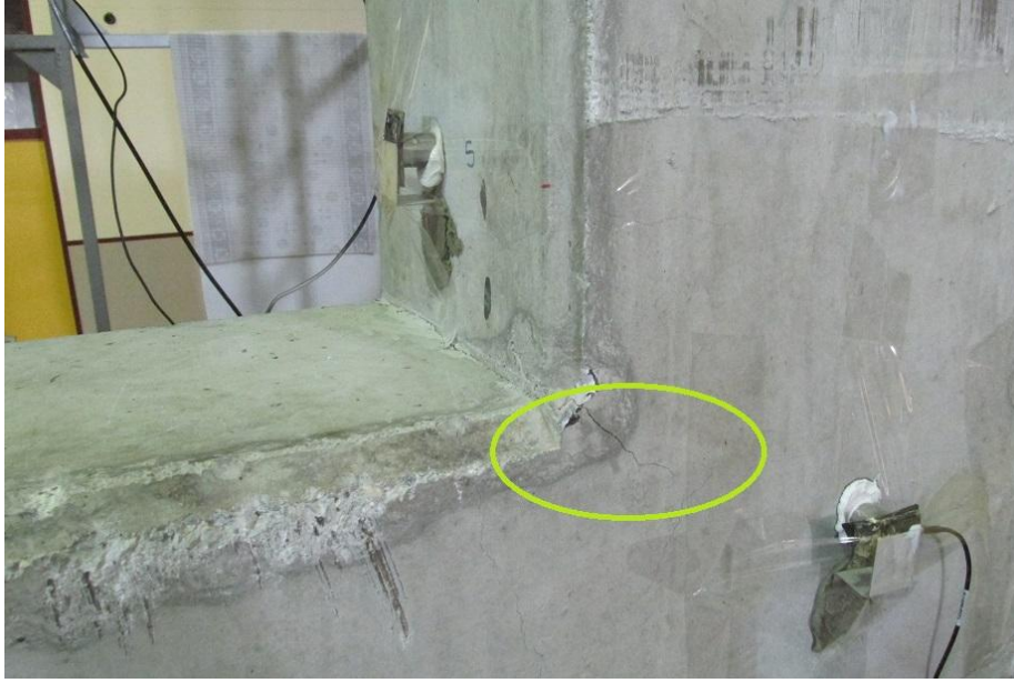
Şekil 5.1.4. Kesme çatlaklarının doğru etriye sayesinde durdurulması
