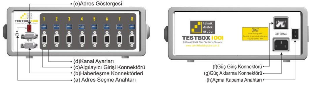
Şekil 3.6.1. Veri toplama sistemi ön panel görünümü ve arka panel görünümü
