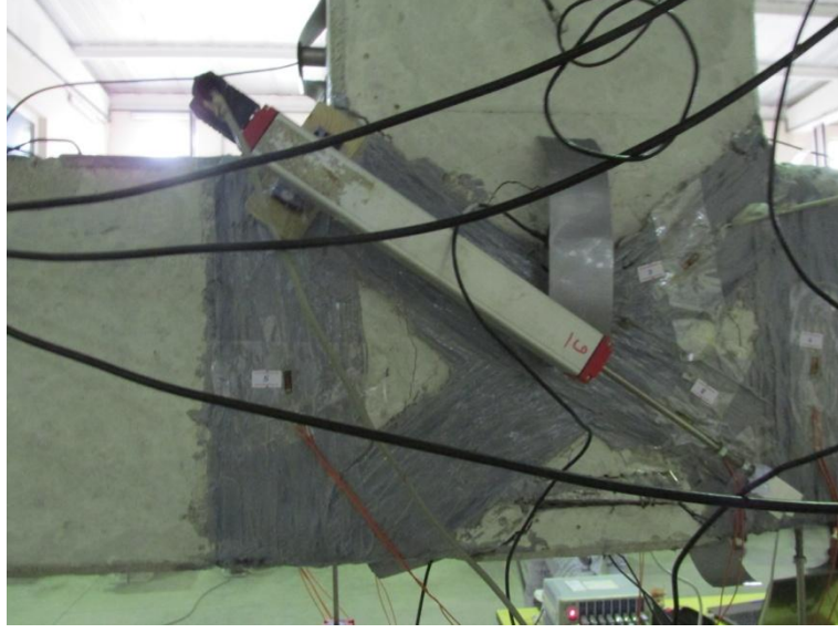
Şekil 5.6.5. Deney sonucunda arka yüzde oluşan çatlaklar
