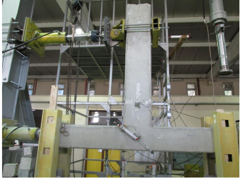
Şekil 5.3.1. Referans Eleman-2 deney düzeneği
