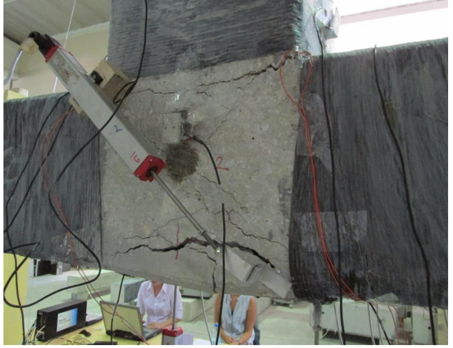
Şekil 5.4.4. Deney sonrası Deney elemanı-4'te oluşan kırılmalar
