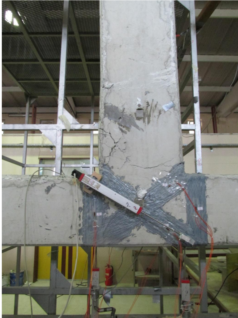
Şekil 5.6.6. Deney sonunda oluşan deformasyonlar
