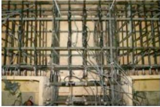
Şekil 2.7. Kolon-kiriş kesişim noktasına CFRP çubukları uygulanması(Sharbatdar ve Saatçioğlu,2011)
