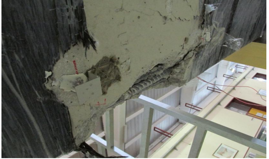
Şekil 5.4.5. Deney sonrası deney elemanı-4'ün altında oluşan kırılmalar
