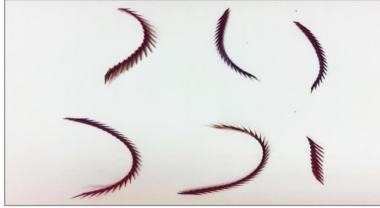
Şekil 4.39 1040 iş parçasından 3.deney şartı için ( V=100\text{m/dak} , f=0.2\text{mm/dev} , a=1.5\text{mm} , i=30^\circ ) kırılan talaşlar
