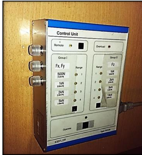
Şekil 4.20 Kistler 5233A model kontrol ünitesi
