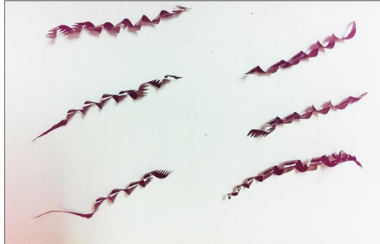
Şekil 4.40 1.2738 iş parçasından 1.deney şartı için ( V=100\text{m/dak} , f=0.05\text{mm/dev} , a=0.5\text{mm} , i=10^\circ ) kırılan talaşlar
