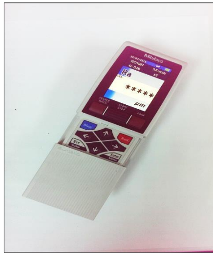
Şekil 4.23 Ölçümlerde kullanılan Mitutoyo marka SJ-210 model pürüzlülük cihazı
