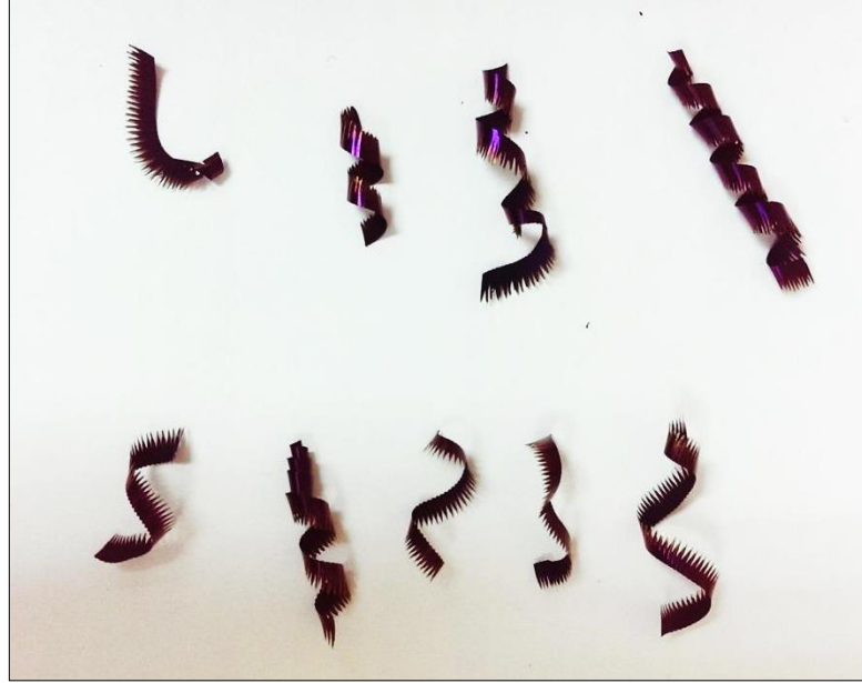
Şekil 4.42 1.2343 iş parçasından 1.deney şartı için ( V=100\text{m/dak} , f=0.05\text{mm/dev} , a=0.5\text{mm} , i=10^\circ ) kırılan talaşlar
