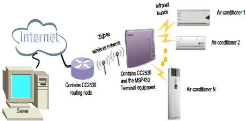
Şekil 1.8 Klima kontrol sistemi [11]
