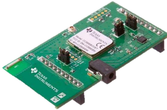
Şekil 2.6 CC3000 BoosterPack kablosuz haberleşme geliştirme kartı [36]
