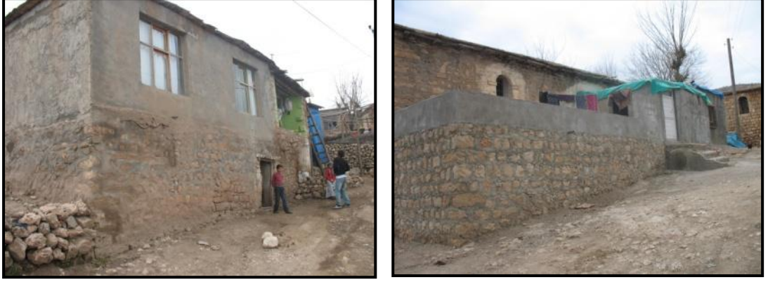
Şekil.3.96. Arazi eğimine göre evlerin üst kat girişinin planlanması (Diyarbakır - Silvan, 2012)
