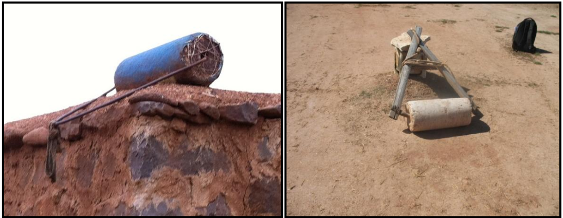
Şekil.3.70 Toprak döşemeyi sıkıştırmak için kullanılan silindir (Diyarbakır, 2012)
