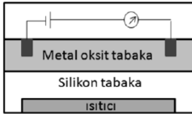
Şekil 1.10. Metal oksit tabanlı yarı iletken gaz sensörü temel bileşenleri.
