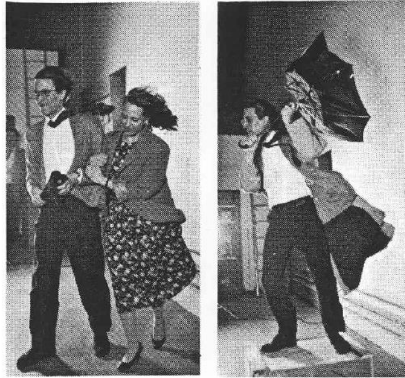
Şekil 2. 3 Rüzgar tüneline 70 km/h rüzgara maruz kalma deneyi [12]
