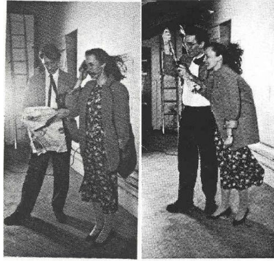
Şekil 2. 2 Rüzgar tüneline 20-40 km/h rüzgara maruz kalma deneyi [12]
