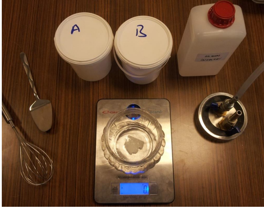
Şekil 6.1 Silikon ped karışımının hazırlanma gereçleri: Hassas tartı, karışım haznesi ve karıştırıcılar
