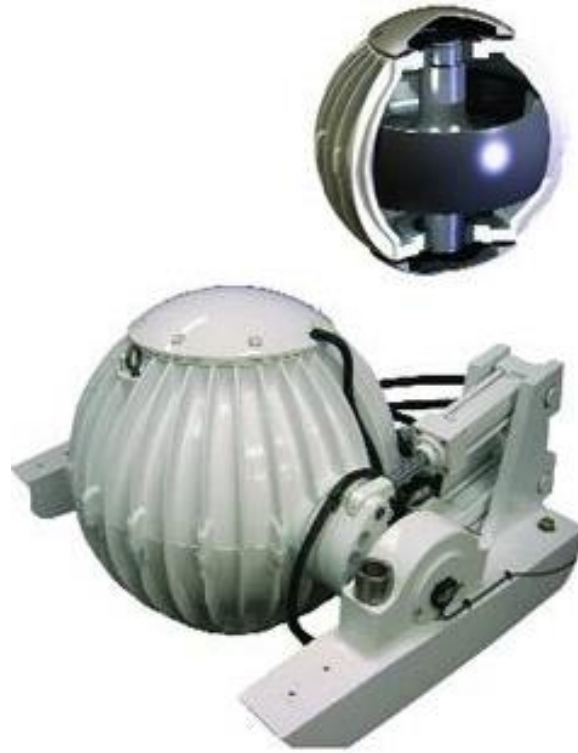
Şekil 4.7. Cayroskop (Seakeeper Gyro)
