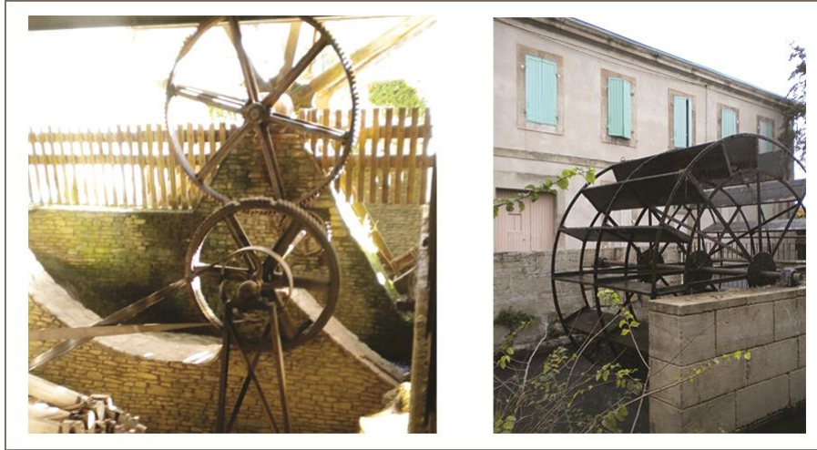
Şekil 2.22 Güney Fransa, Avignon, Isle-sur-sorgue, endüstriyel üretimde kullanılan metal su çarkı ve güç aktarım dişlileri (Çorapçıoğlu,2011).
