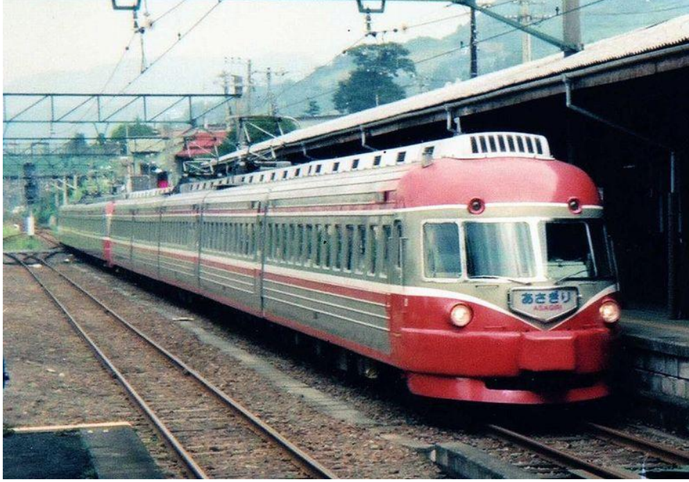
Şekil 2,2.Dünyada kullanılan dar hat alanlı ilk hızlı tren Ro-mancecar 3000 SSE
