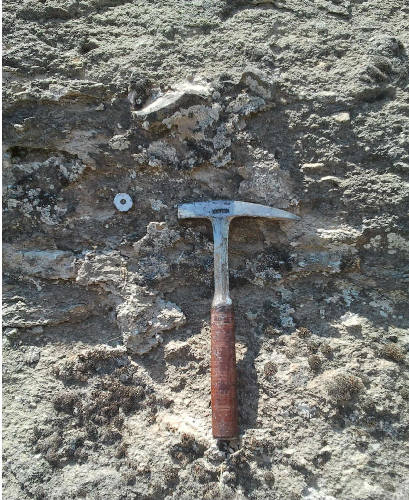
Şekil 4.50. Ketenli formasyonuna ait tüflerde kuvvetli manyetizma (Mıknatıs düşey yönlü durmaktadır; Yer: Kayalı Köyü kuzeyi)
