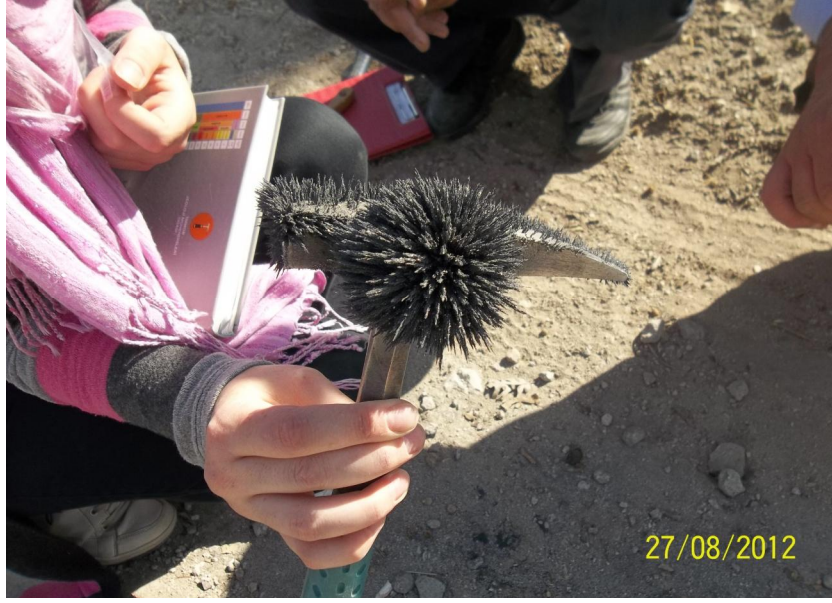
Şekil 4.49. İnceleme alanında gözlenen manyetitlerin mıknatıs üzerindeki görüntüsü
