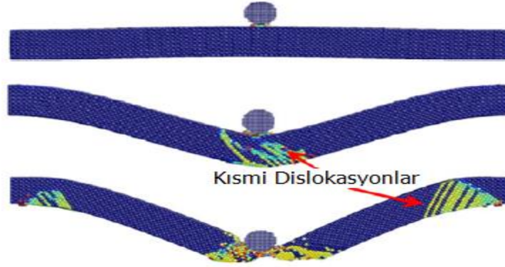
Şekil 2.11. Bakır nano tellerin MD ile incelenmesinde kullanılan atomik modelin görüntüsü [52].
