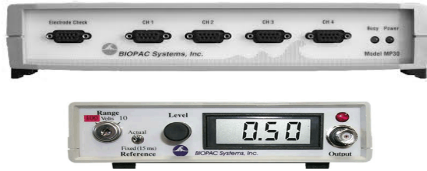
Resim 3.4. BSL MP 30 sistemi ve bu sisteme ait voltaj stimülatörü
