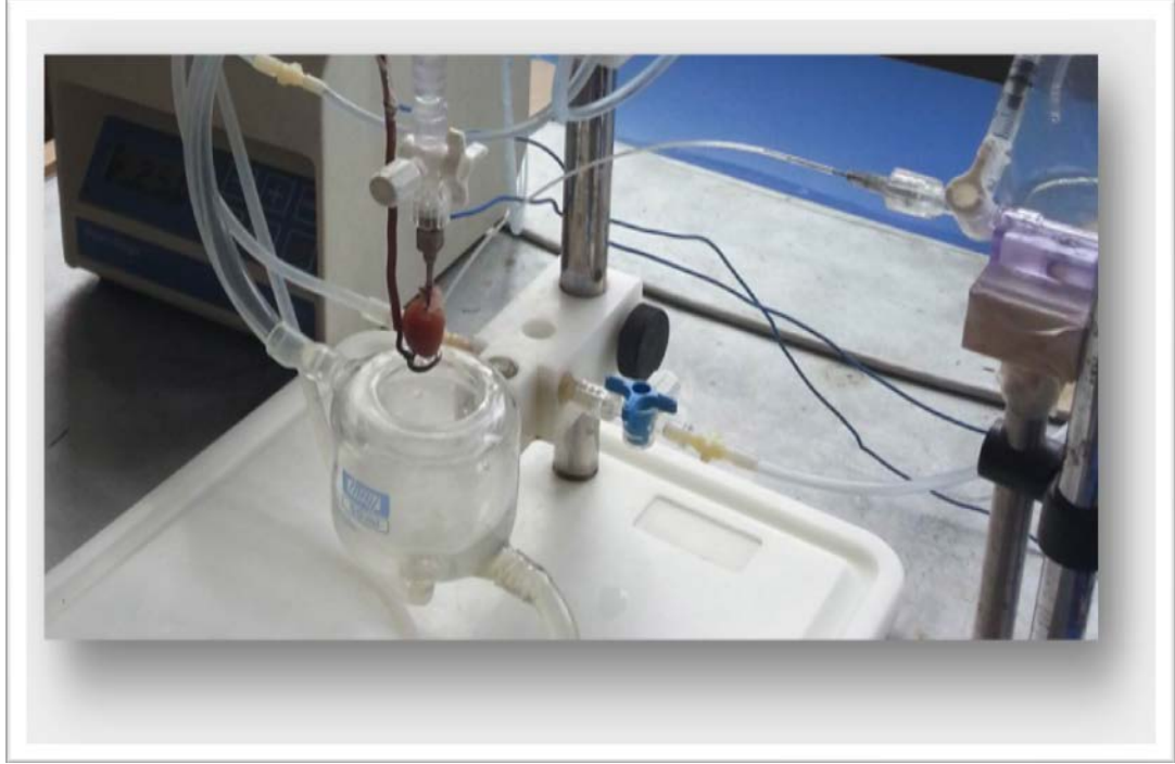
Resim 3.1. Langendorff sistemine sabitlenmiş izole kalp preparatı
