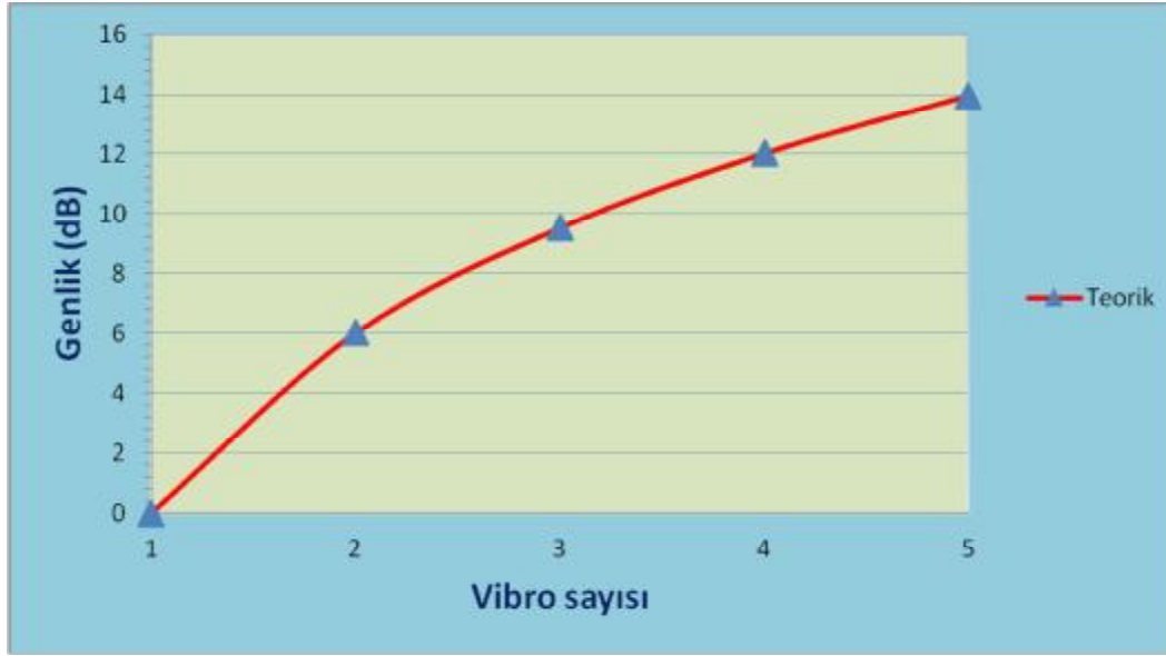
Şekil 3.53. Farklı vibro sayısı ile oluşturulan sweep sinyalinin hesaplanan otokorelasyon dalgacığının teorik genlik değerleri (Gürel, 2008)
