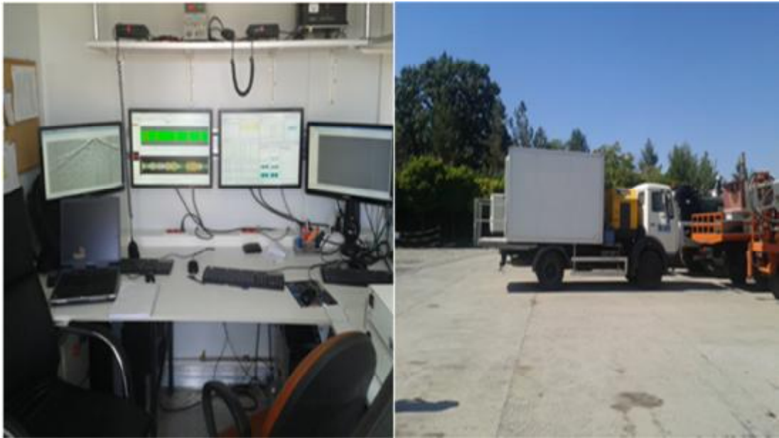
Şekil 4.1. Sismik kayıtçı kamyonu ve içeriden görünümü
