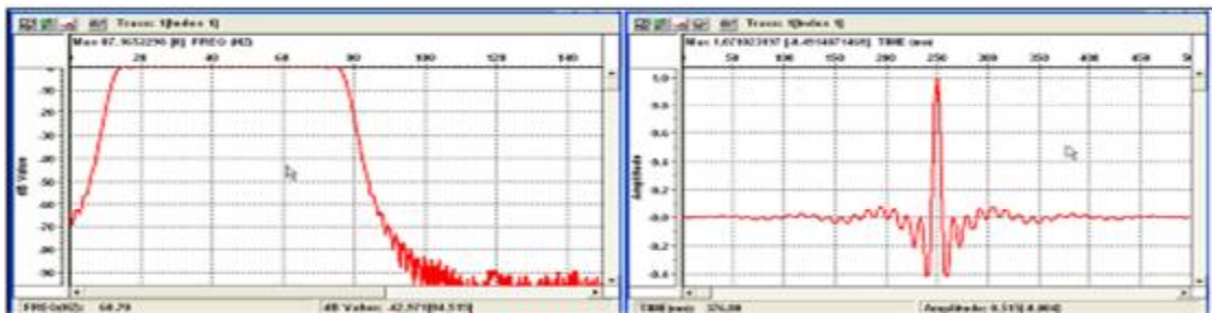
Şekil 3.51. Frekans bandı 10-80 Hz olan sinyal (a) genlik spektrumu (b) otokorelasyon dalgacığı (Sakallıoğlu ve diğ., 2012)
