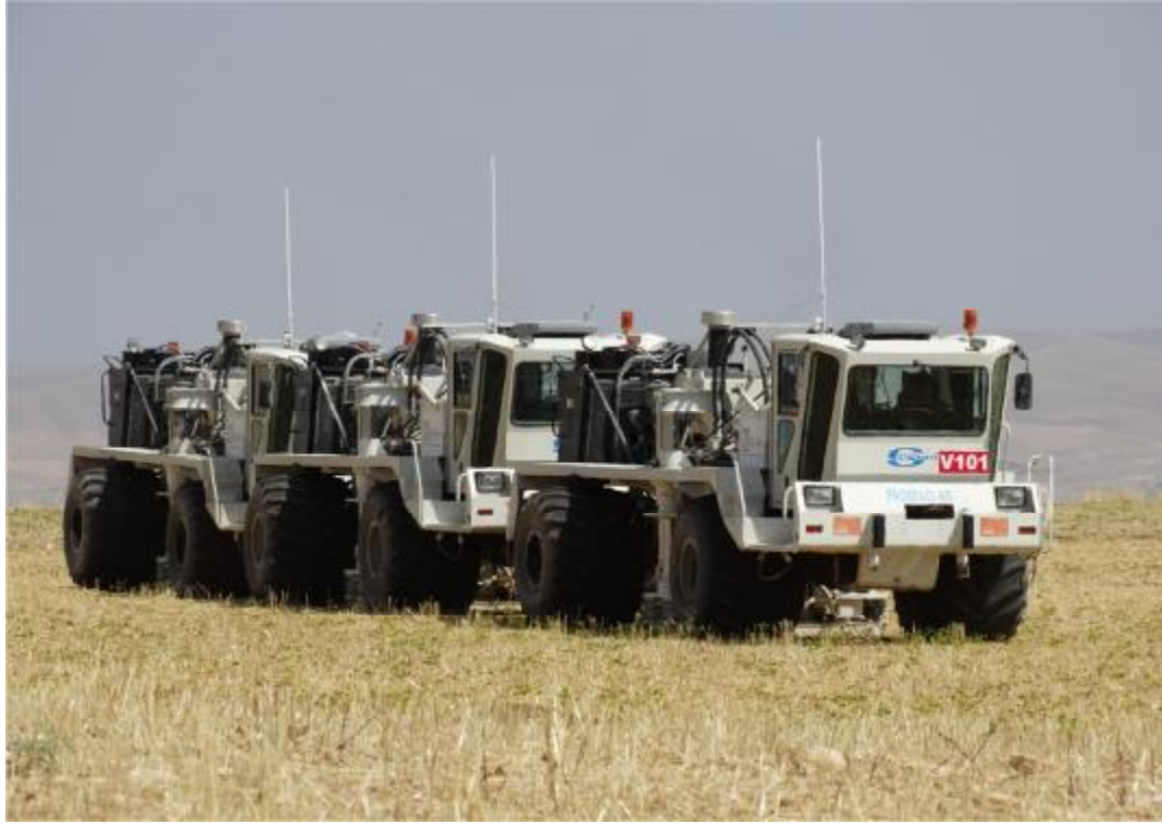
Şekil 3.18. Sercel - Nomad 65 Vibrosismik kaynak - Arazi çalışmalarından
