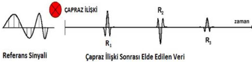
Şekil 3.25. Sweep Sinyali ile Vibrosismik verisinin kroskorelasyon işlemi (Sakallıoğlu, 1992)
