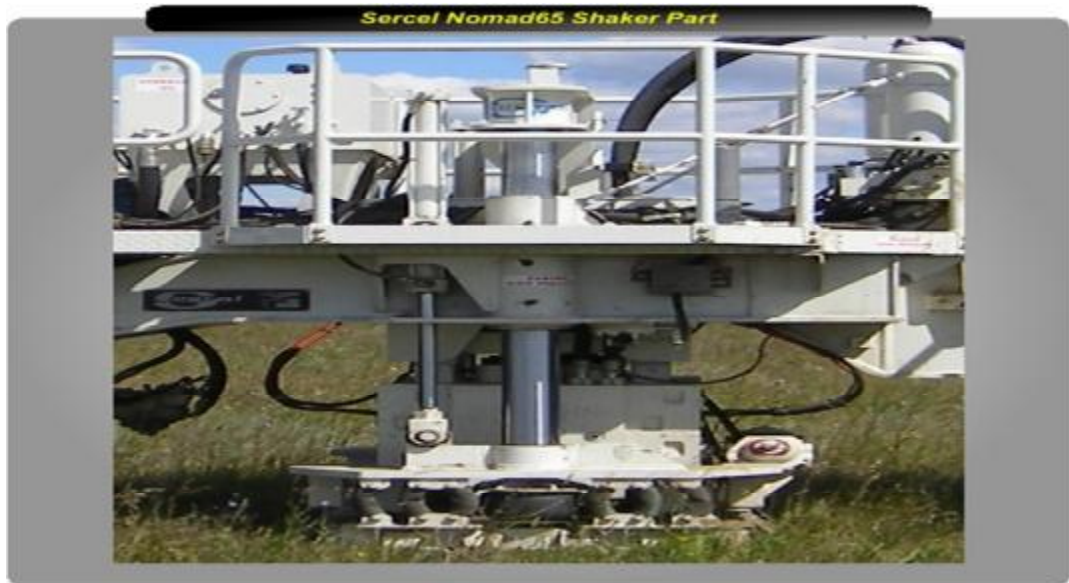
Şekil 3.19. Sercel - Nomad 65 - Vibratör hareketli sistemi (Sercel 428 XL Training course; Acquisition System & Source Controller, 2013, Ankara)
