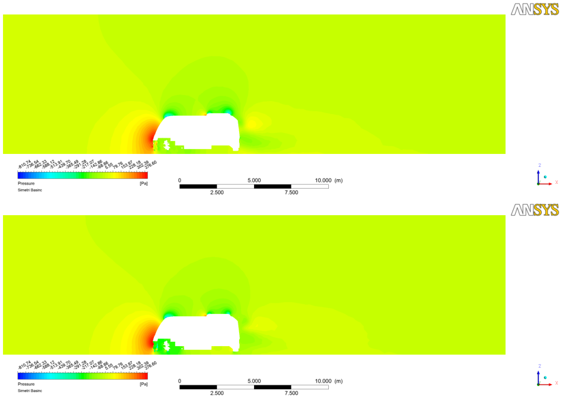
Şekil 4. 3 Merkez Eksende Basınç Dağılımı - Genel Görünüm
