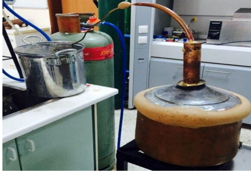
Şekil 3. 2. Çalışmada kullanılan ev yapımı bakır damıtma kazanı
