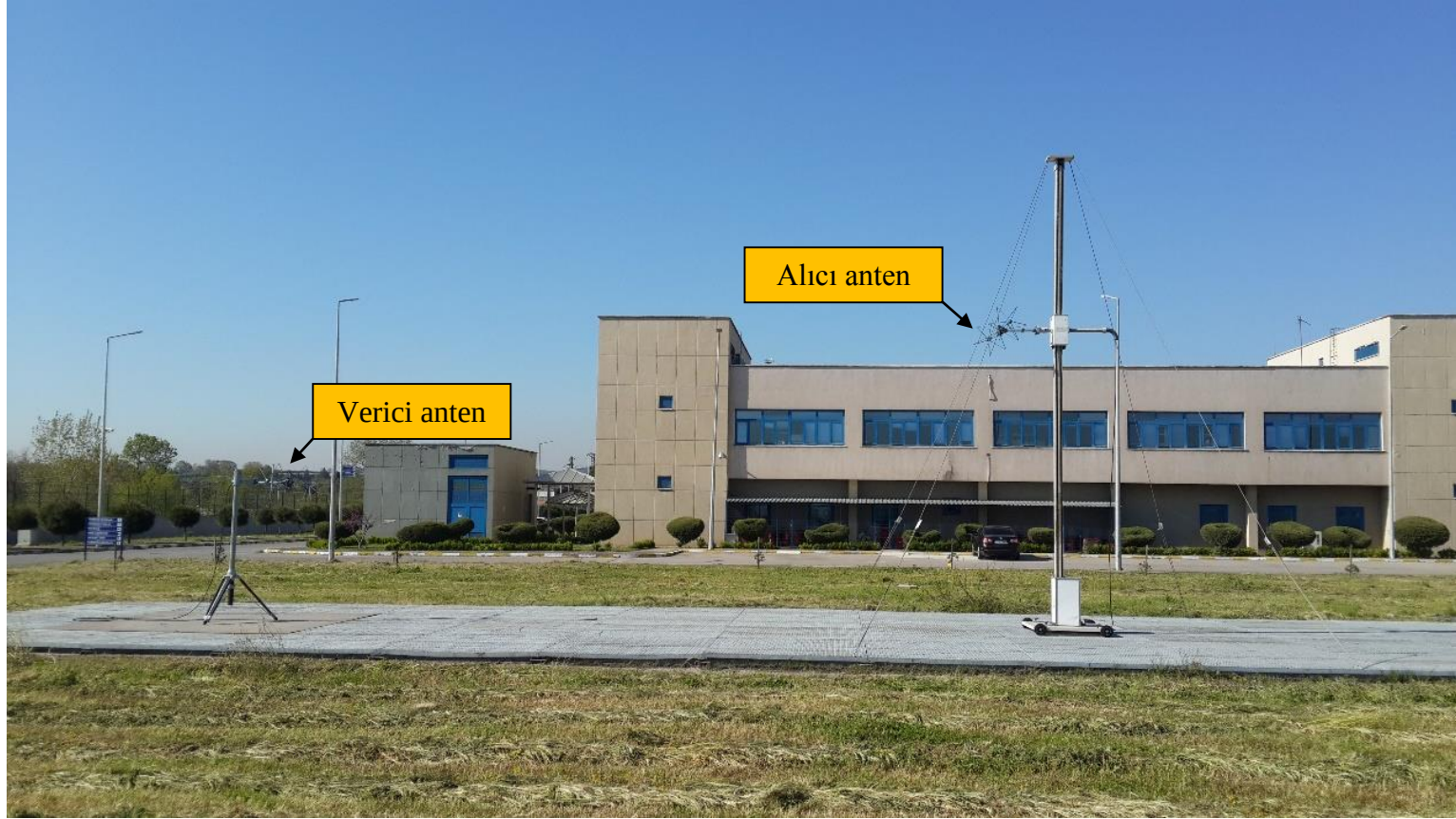
Şekil 4.1 : Bikonik anten kalibrasyonu saha ölçümlerinden bir görünüş.
