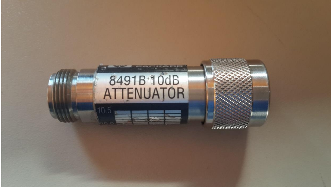
Şekil 2.4 : Ölçüm ekipmanlarından 10 dB zayıflatıcı.
