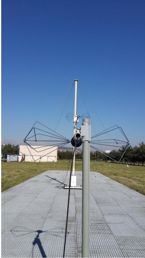
Şekil 4.2 : Bikonik anten kalibrasyonundan bir kesit.
