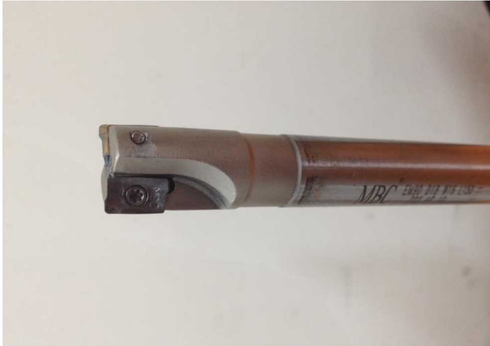
Şekil 3.6. Kaba İşleme İçin Kullanılan Kesici Takım
