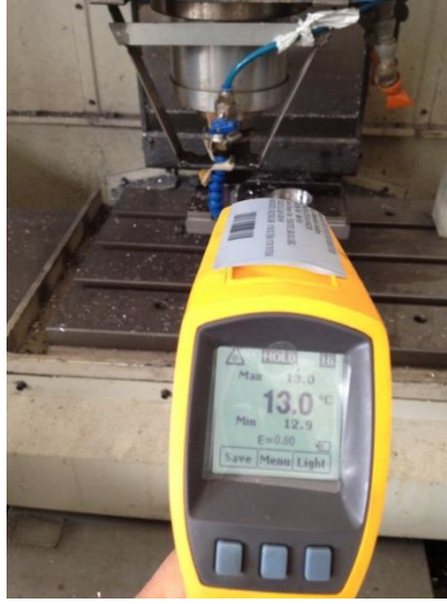
Şekil 3.9. Kızıl Ötesi Sıcaklık Ölçer ile İş parçası Sıcaklık Ölçümü
