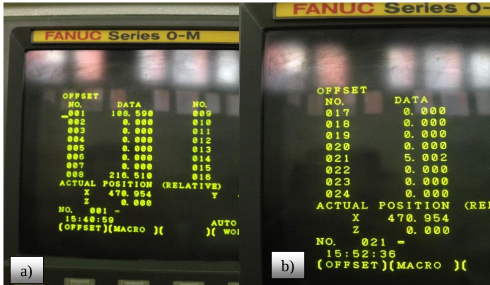
Şekil 3.5.Takım Ölçme Probu ile Elde Edilen a)Takım Boy ve b)Çap Değerleri
