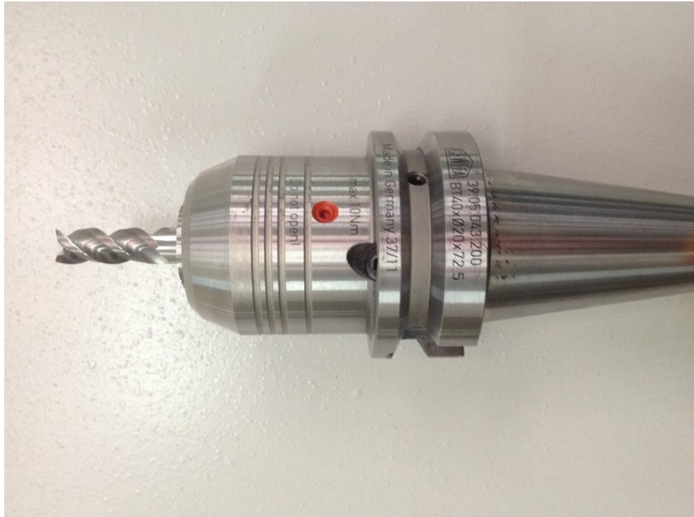
Şekil 3.7. İnce İşleme İçin Kullanılan Kesici Takım ve Hidrolik Tutucu
