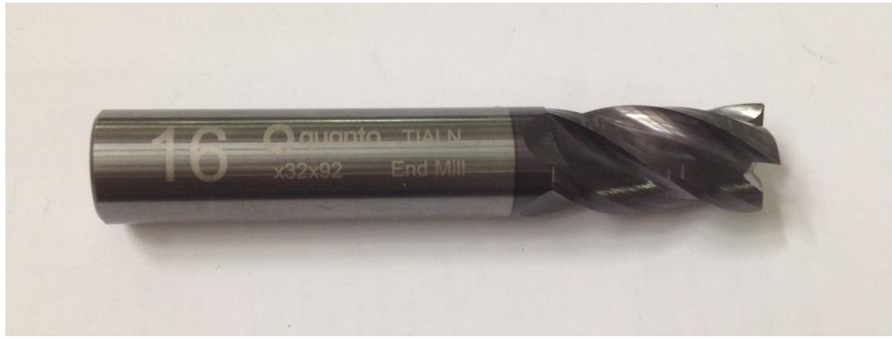
Şekil 3.8. İnce İşleme İçin Kullanılan Kesici Takım
