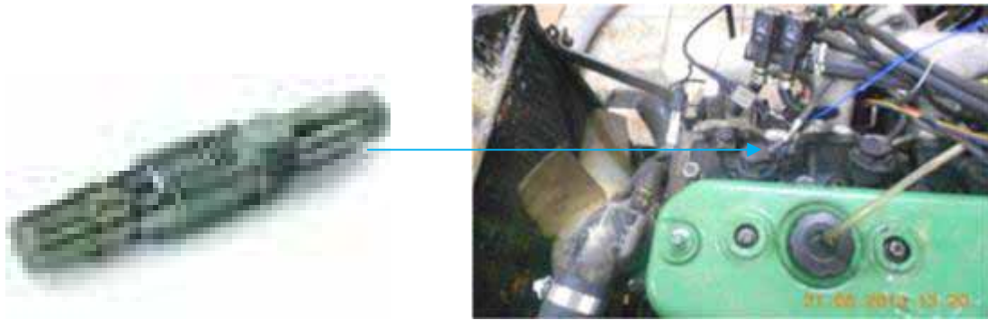
Şekil 2.15. PCB 112A05 model silindir içi basınç sensörü ve motorda yerleşimi.
