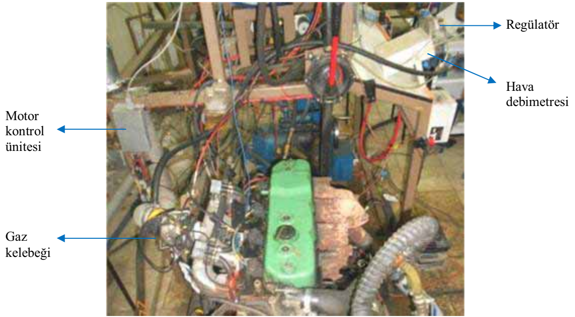
Şekil 2.6. Gaz yakıtları ve havanın temininde kullanılan komponentlerin görünümü.
