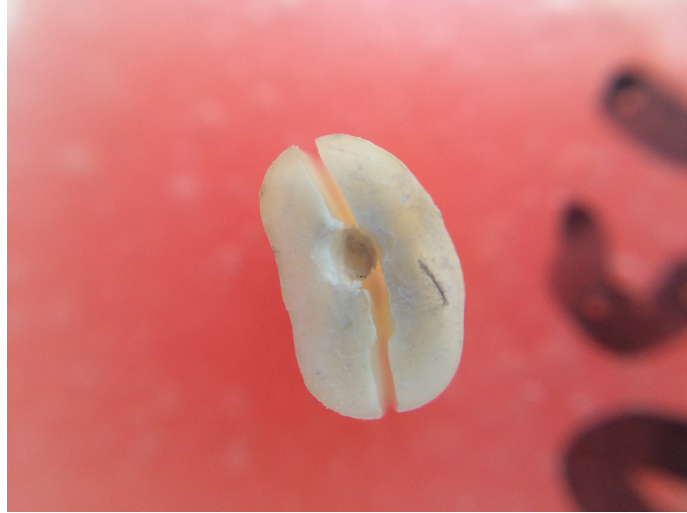
Resim 5.39: İnstron cihazına bağlanan örneklerin kırıldıktan sonraki görüntüsü - 2
