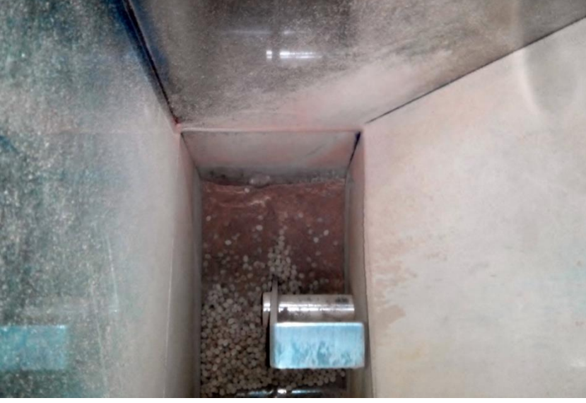
Şekil 3.8. Ekstruder haznesinden malzemelerin beslenmesi
