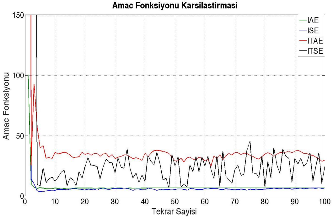
Şekil 6.3. GA PID ile yükseklik kontrolünde farklı kriterler için amaç fonksiyon değerlerinin değişimi
