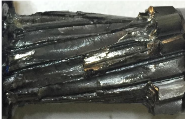
Şekil 4. 12 İlk deney sonucunda numune dişlide oluşan hasar
