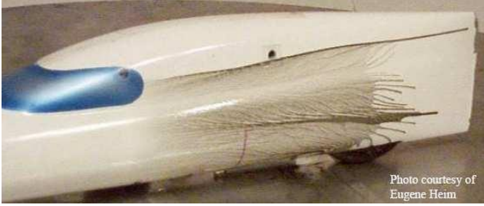
Şekil 3.4. Hızlı tren modeli üzerinde akışın görüntülenmesi [33]
