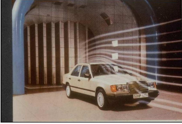
Şekil 3.2. Duman tekniği kullanılarak yapılan aerodinamik testler [31]
