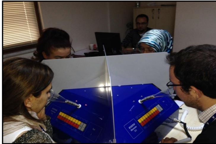
Şekil 3.13 : Dinamik olfaktometre TO8 ve analizi gerçekleştiren panelistler.
