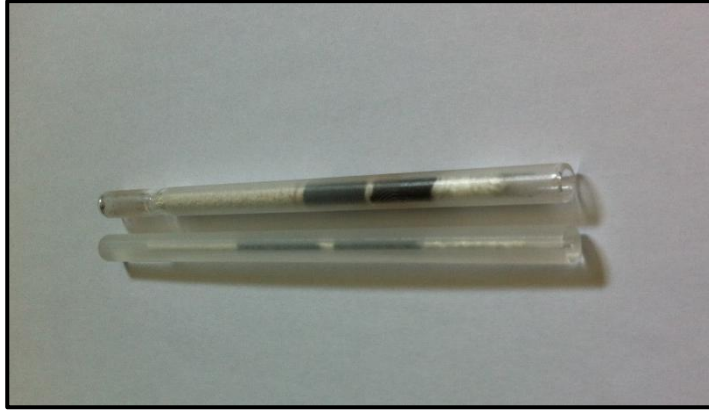
Şekil 3.7 : 20:35 Tenax-TA™, 60:80 Carboxen™ 1000, 60:80 Carbosieve™ içeren sorbent tüp.
