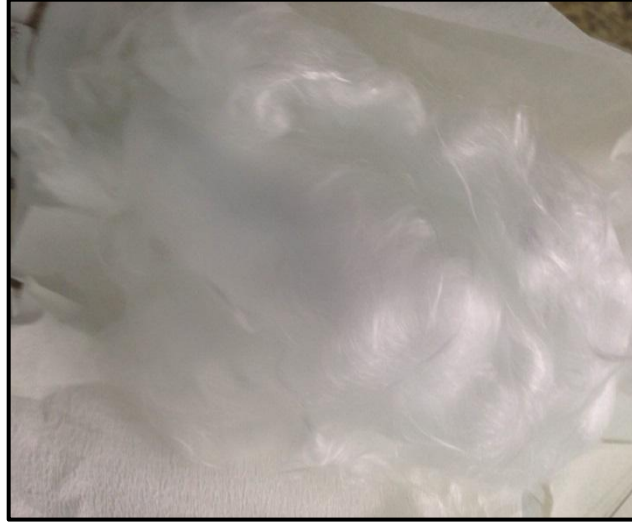
Şekil 3.21 : Sorbent tüp yapımında kullanılan cam yünü.
