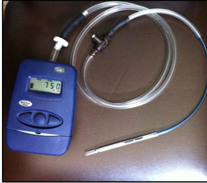
Şekil 3.1 : AirCheck 3000 pompa ve tenax tüp ile aktif numune örnekleme seti.
