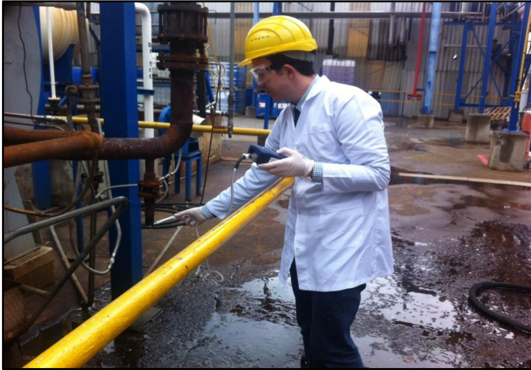
Şekil 3.26 : Yalova metilamin üretim tesisinde insineratör girişinde sorbent tüp ile aktif UOB örnekleme.
