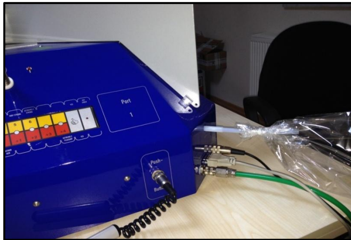
Şekil 3.14 : Olfaktometre ve tedlar torba ile örneklenen numune.
