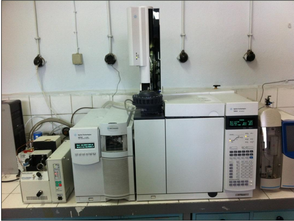
Şekil 3.2 : Analitik ölçüm için kullanılan TD/GC/MS sistemi.
