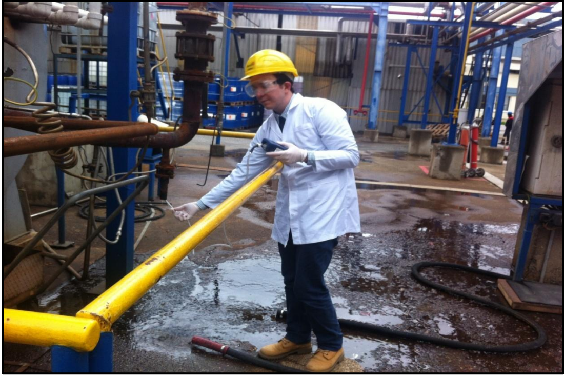
Şekil 3.27 : Yalova metilamin üretim tesisinde insineratör girişinde sorbent tüp ile aktif UOB örnekleme 2.
