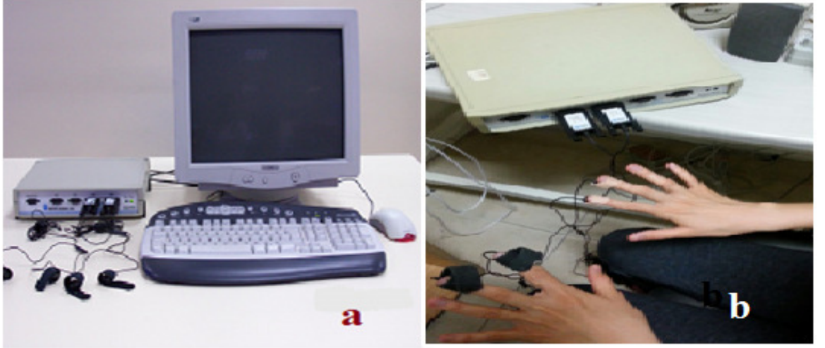
Resim 3.1. a) MP30 sistemi ile kayıt alınan bilgisayar Resim 3. 1. b) EDA kaydı için izole odada gönüllüye elektrot yerleşimi ve MP30 Sistemi
