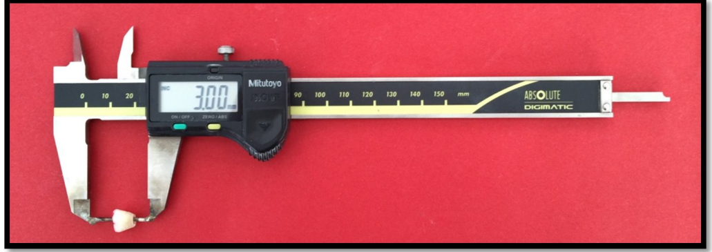
Şekil 2.7. Dijital kumpas ile dentin kalınlığının ölçülmesi
