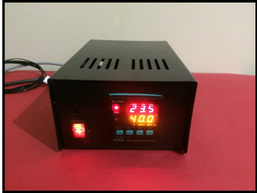
Şekil 2.23. Enda ETC 4420 veri kayıt cihazı
