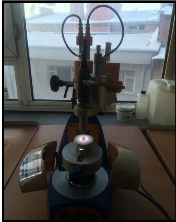
Şekil 2.8. Paralelometre cihazı ile kavitelerin açılması
