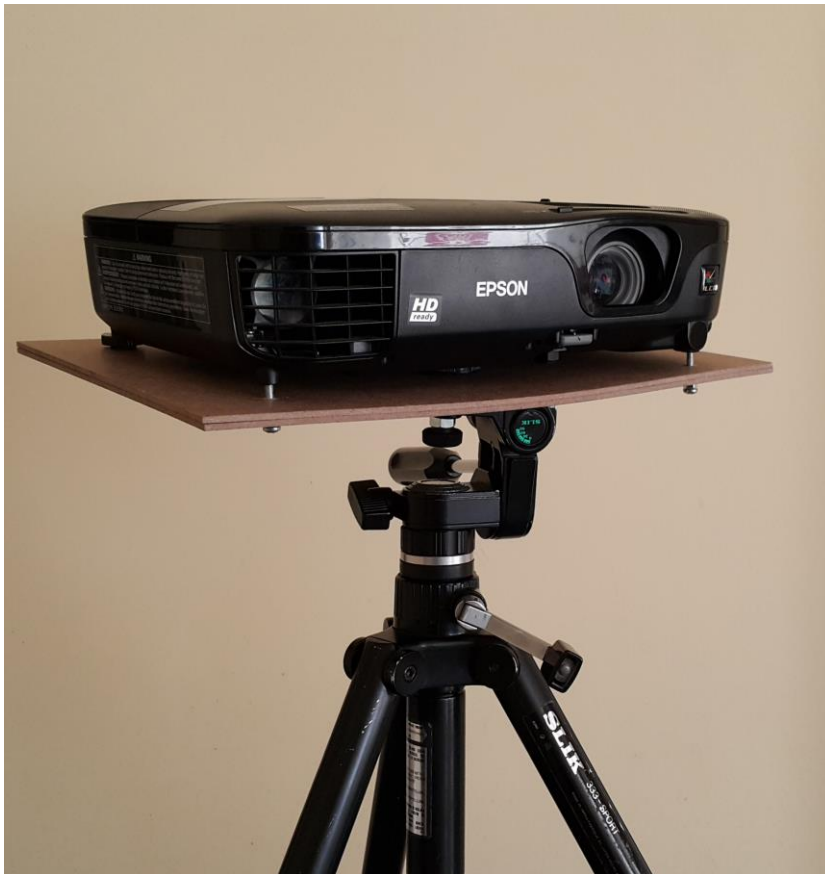
Görüntü 4-11 Projeksiyon cihazının tripod ile bütünleştirilmesi.
