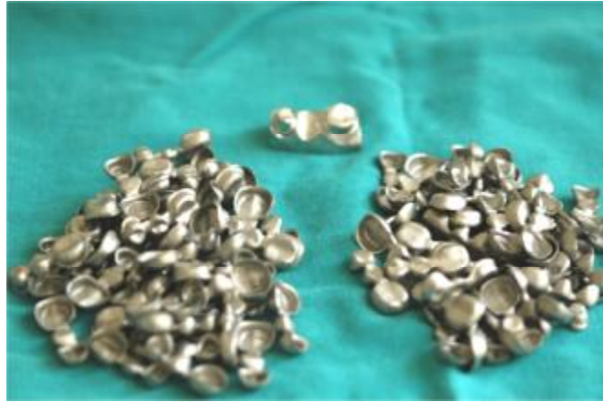
Şekil 3. 3. Lehim işlemine hazır hale getirilmiş örnekler.
