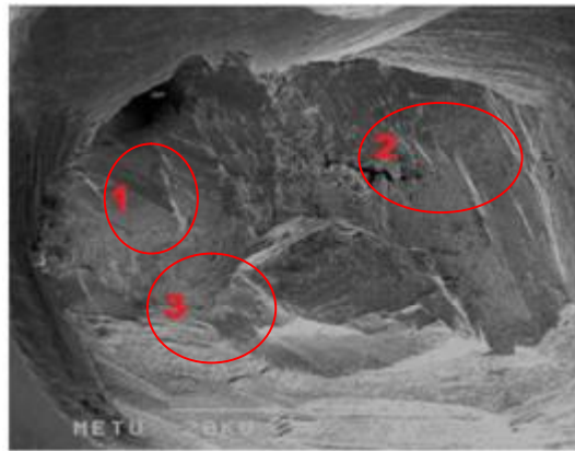
Şekil 4. 1. L_{kont} örneğine ait \times 35 büyütme altında elde edilen kırık yüzey görüntüsü.
